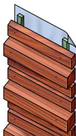
Tekening 2 Horizontale open gevelbekleding met variabele afmetingen, trapeziumvormig voor goede afwatering.
